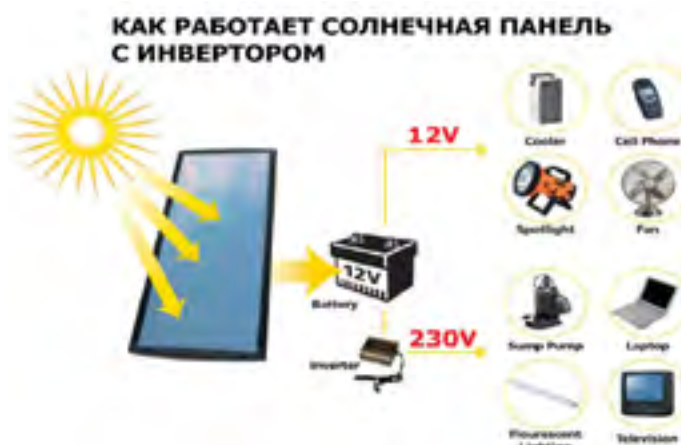
Рис.1. Принцип работы солнечной панели инвертора
