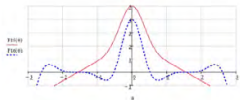
Рис.7 Графики рабочей эффективности фрактальной антенны и традиционной
