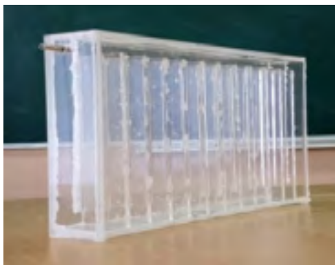
Рис. 7. Действующая модель батареи противоточной системы обогрева
